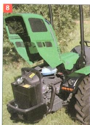
8 - Cofano con eccellente apertura: libera perfettamente il radiatore.
